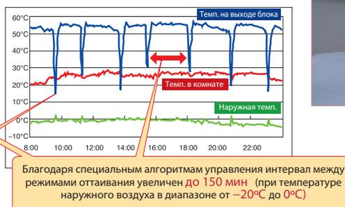
Пример эксплуатации наружного блока
