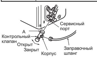
Если при креплении контрольного клапана к сервисному порту прилагать чрезмерное давление, сердечник клапана может деформироваться или открутиться. Это может привести к утечке газа.
