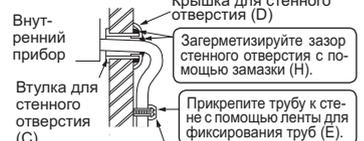
Отрежьте лишнее. Лента для фиксирования труб (E) Шуруп крепления (F)
